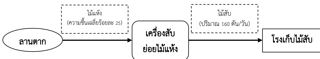
ภาพที่ 21 แสดงขั้นตอนการสับย่อยไม้แห้ง (ความชื้นเฉลี่ยร้อยละ 25)
