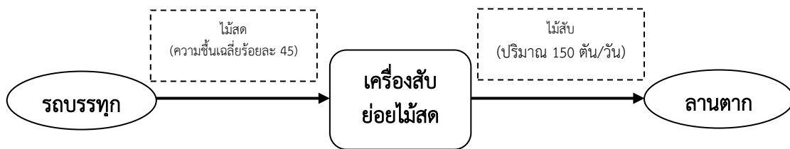
ภาพที่ 20 ขั้นตอนการสับย่อยไม้สด (ความชื้นเฉลี่ยร้อยละ 45)
