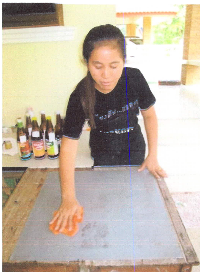
ภาพที่ 29 การทาแลคเกอร์ลงบนแม่พิมพ์
