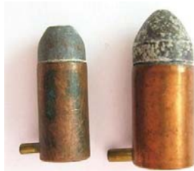
ภาพที่ 10 กระสุนแบบ Pin fire ( ด้านซ้ายขนาด 7 มม. – ด้านขวาขนาด 9 มม.)
