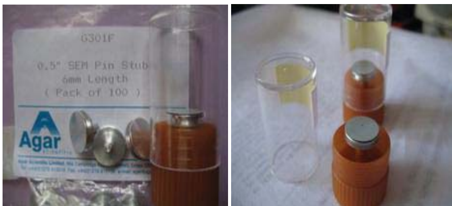
ภาพที่ 68 Stub และภาชนะบรรจุ
