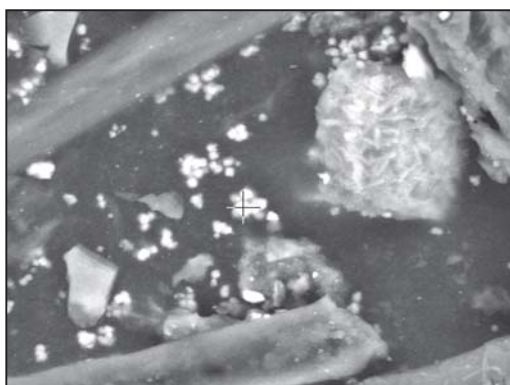
ภาพที่ 104 ภาพแสดงลักษณะของอนุภาค และกลุ่มของอนุภาคเขม่าป็น ที่เก็บตัวอย่างมาจากบริเวณ แขนเสื้อ ซึ่งอนุภาคมีลักษณะค่อนข้างกลม
