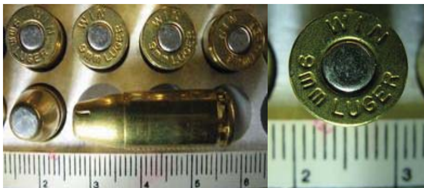
ภาพที่ 14 ตัวอย่างกระสุนปืนแบบ Center Fire (ในภาพเป็นกระสุน Winchester รุ่น Winclean™)
