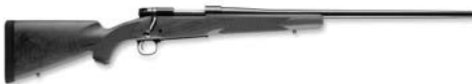
ภาพที่ 7 อาวุธปืน Winchester model 70, sporter deluxe, bolt-action rifle ขนาด 270 win. ของกระสุน (magazine) บรรจุกระสุนปืนได้ 5 นัด
