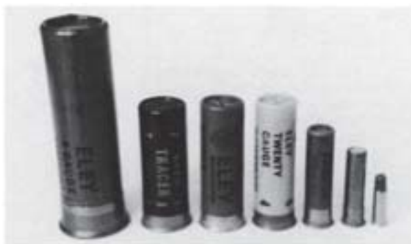
ภาพที่ 12 ตัวอย่างกระสุนปืนแบบ rim-fire สำหรับอาวุธปืนลูกซอง ขนาดต่างๆ (จากซ้ายไปขวา) gauge 4, 12, 16, 20 ขนาด .410 นิ้ว ขนาด 9 มม. และลูกกรดขนาด .22 นิ้ว
