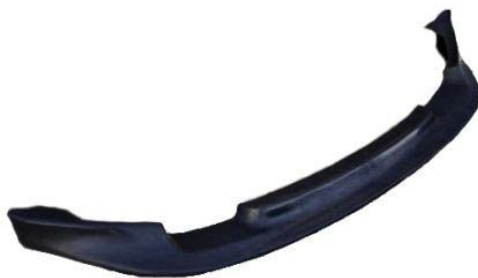
ภาพที่ 43 พลาสติกส่วนริมฝีปากของกันชนหน้าทำมาจากโพลียูเรเทน
