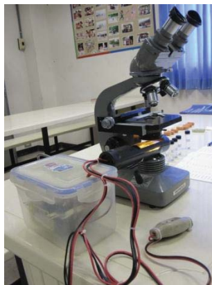
ภาพที่ 53 การจัดวางตำแหน่งของหลอดไฟโซเดียม
