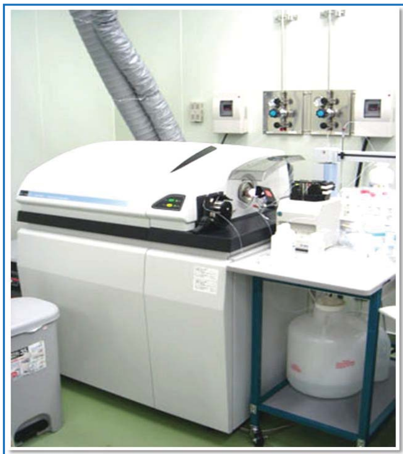
ภาพที่ 37 เครื่อง Inductively Coupled Plasma - Mass Spectrometer (ICP - MS) ของ กลุ่มงานตรวจอาวูรปุ่นและเครื่องกระสุน กองพิสูจน์หลักฐานกลาง
