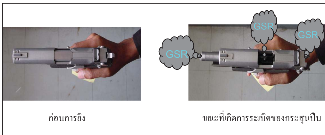
ภาพที่ 6 บริเวณที่เขม่าปืนสามารถออกมาได้ในปืนพกออโตเมติก
