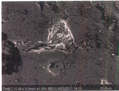
a) ผิวชิ้นงานเกิด Three Body Abrasive Wear b) ผิวชิ้นงานเสียหายแบบ Surface Delamination
