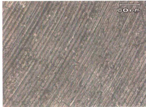
a) ผิวชิ้นงานจากการทำ Milling
