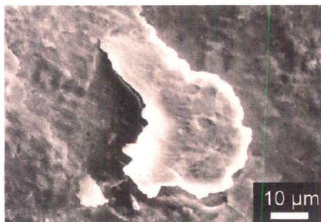
รูปที่ 4 ซ้ายมือ) ภาพ SEM แสดงเศษเม็ดเหล็ก SEM บนผิวโลหะไททาเนียม ขวามือ) ผลการวิเคราะห์ด้วย Energy Dispersive X- ray analysis (EDX) [1]
