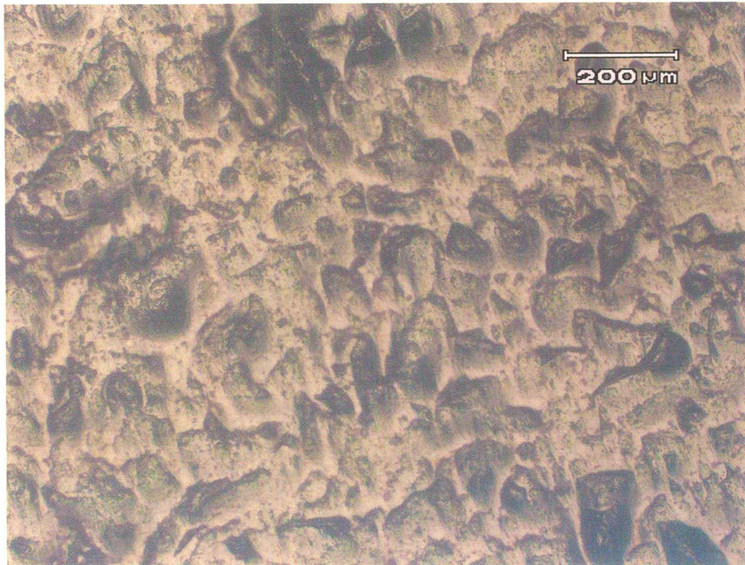
ภาพแสดงลักษณะผิวการยิงเม็ดเหล็กและเคลือบผิวด้วย TiN ก่อนการทดสอบ Fretting Wear
