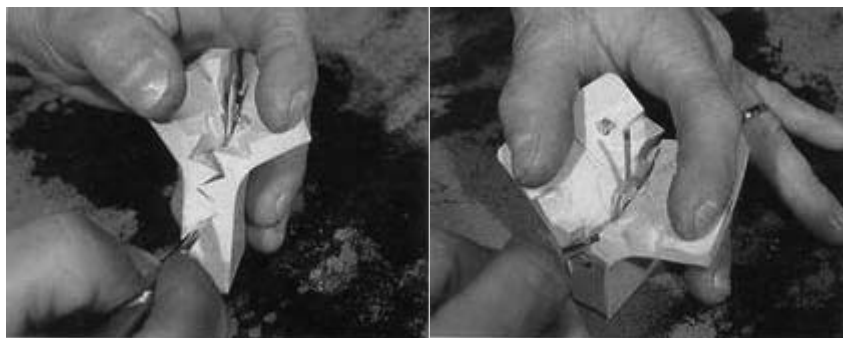
ภาพที่ 24 การการผ่าพิมพ์ยางด้วยใบมีด
