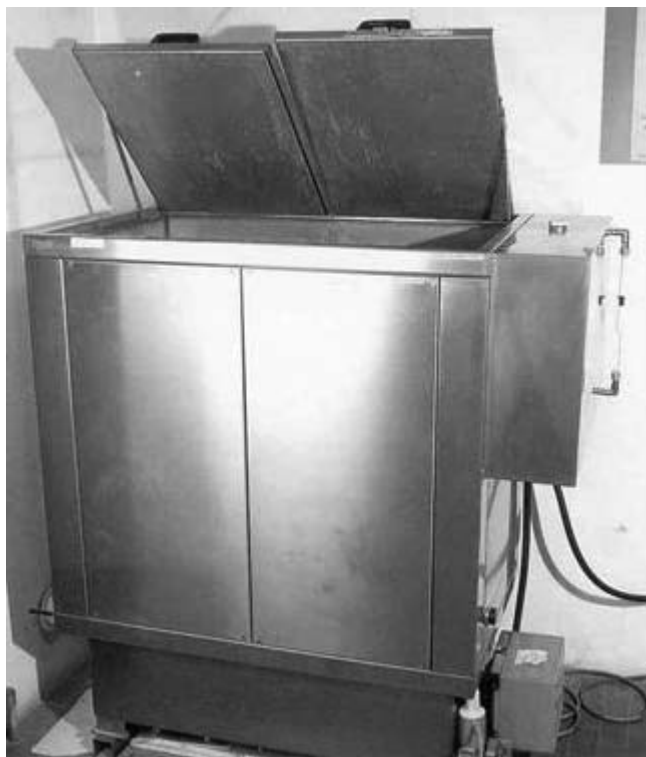
ภาพที่ 33 เตาอบเพื่อละลายเทียนจากกระบอกปืน
