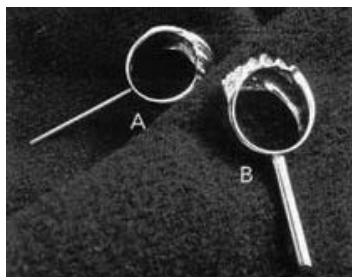
ภาพที่ 22 แม่พิมพ์โลหะพร้อมก้นรูเข้า (A) ขนาดเล็กไป (B) ขนาดพอดี
