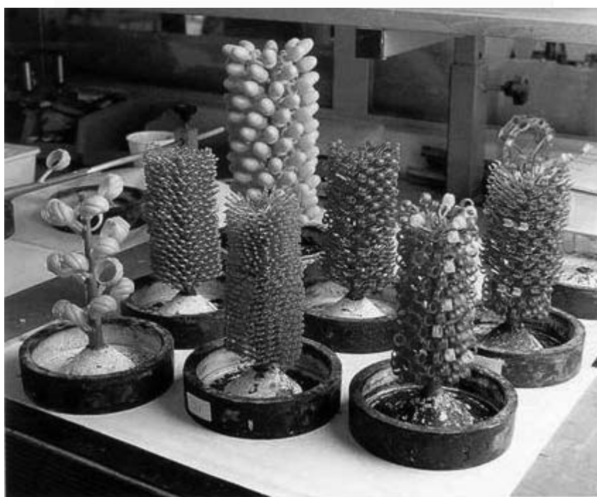
ภาพที่ 28 การผสมปูนปาสเตอร์และการเทหุ้มผิวดันเทียน
