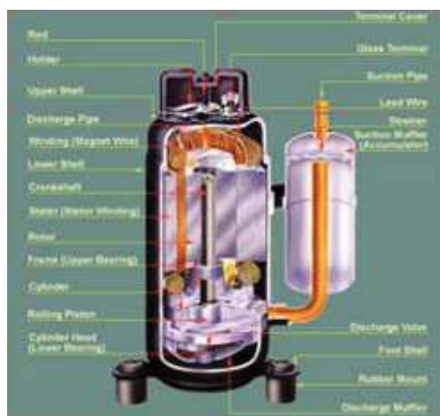
ภาพที่ 13 คอมเพรสเซอร์ยูนิตแบบโรตารี ที่มา: Siam Compressor Industry (SCI)
