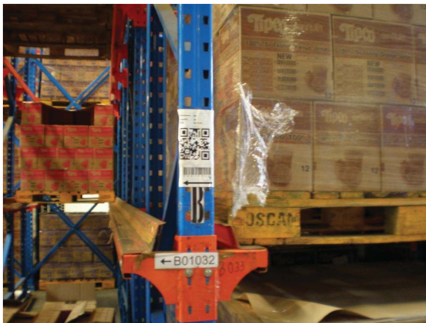
ภาพที่ 56 แสดงภาพของ Barcode ติดเพื่อแสดง Location ที่ใช้จัดเก็บ
