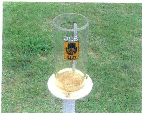
ภาพที่ ค9 กระบอกวัดน้ำฝนเตือนภัยของกรมป้องกันและบรรเทาสาธารณภัย ณ ที่ทำการอบต.ท่าลาดขาว อ.โคกชัย
