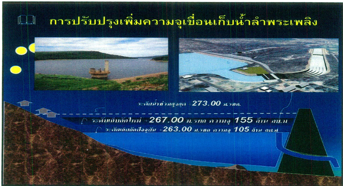
รูปที่ 2.6-2 แสดงการปรับปรุงเสริมระดับเก็บกักน้ำของเขื่อนลำพระเพลิง
