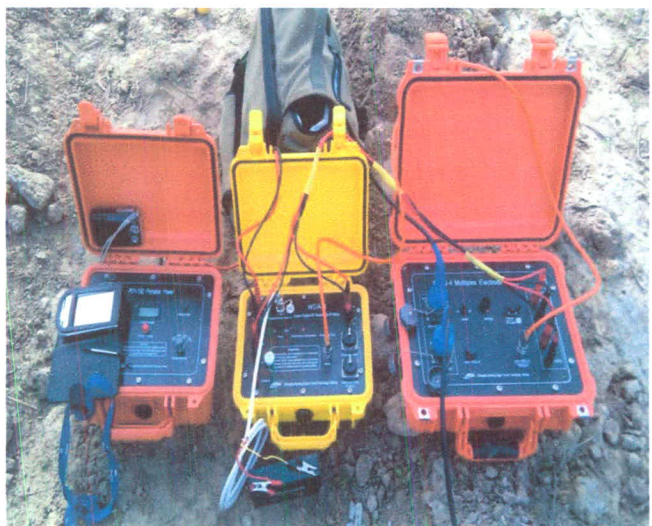
ภาพที่ 3-5 การจัดวางเครื่องมือสำรวจวัดค่าสภาพต้านทาน ไฟฟ้า WDA-1
