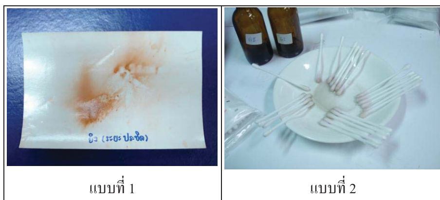
ภาพที่ 12 ภาพแสดงการเกิดสีของสารประกอบไนไตรท์ ด้วยวิธี Modified Greiss Test แบบที่ 1 และ 2
