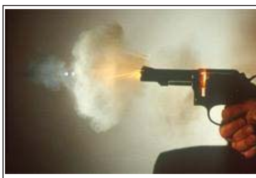
ภาพที่ 15 บริเวณที่ GSR สามารถออกมาได้ ในปืนพกรีวอลเวอร์
