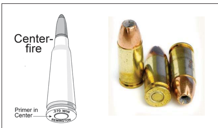
ภาพที่ 6 โครงสร้างกระสุนปืนแบบ Center Fire
