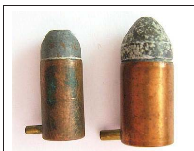
ภาพที่ 4 โครงสร้างกระสุนปืนแบบ Pin Fire
