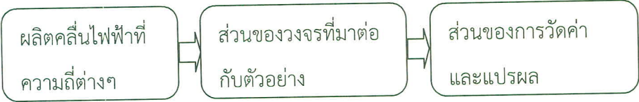
ภาพที่ 3-12 หลักการทำงานของเครื่องทดสอบสมบัติทางไฟฟ้า Impedance/Gain-Phase Analyzer (HP-4194A)
