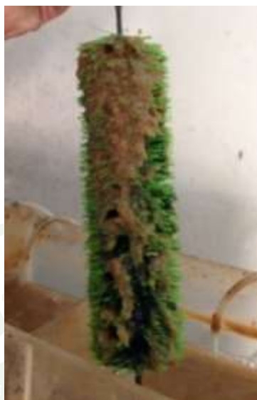
ภาพที่ 34 การเกาะติดของจุลินทรีย์บนตัวกลางพู่กรอง
