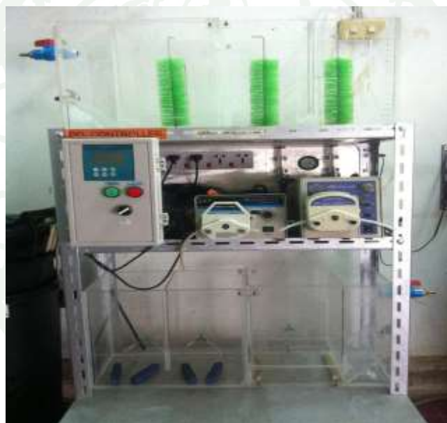
ภาพที่ 19 การติดตั้งแบบจำลองระบบเลี้ยงตะกอนที่ใช้ในการทดลอง
