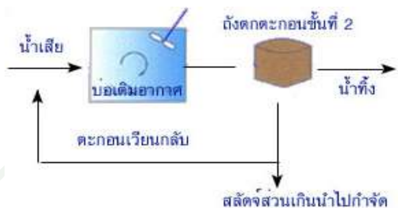
ภาพที่ 2 ระบบบำบัดน้ำเสียทางชีววิทยาแบบเลี้ยงตะกอน
