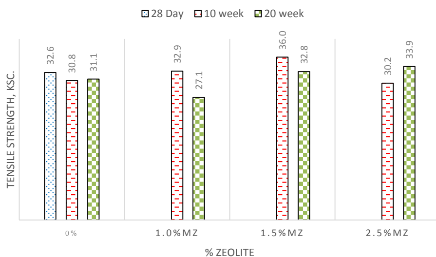
ภาพที่ 39 กำลังรับแรงดึงเฉลี่ยของคอนกรีตที่แทนที่ซีเมนต์ด้วยซีโอไลท์สังเคราะห์ปรับปรุง
