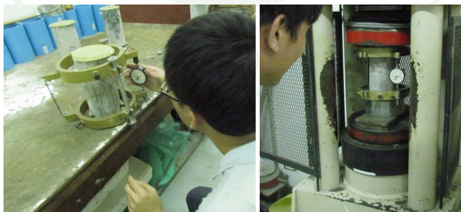
ภาพผนวกที่ ก8 การติดตั้งอุปกรณ์ทดสอบค่าโมดูลัสยืดหยุ่น และการทดสอบค่าโมดูลัสยืดหยุ่น
