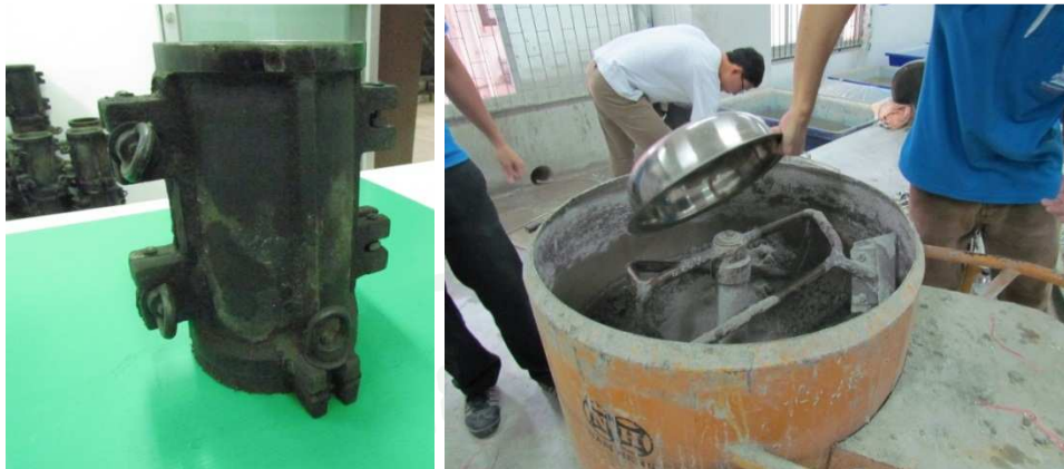
ภาพผนวกที่ ก6 แบบหล่อทรงกระบอก และเครื่องผสมคอนกรีต
