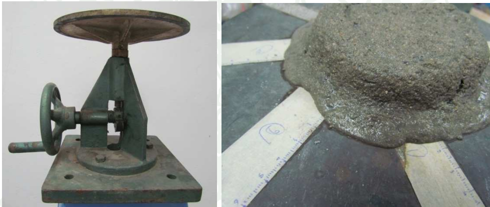
ภาพผนวกที่ ก10 อุปกรณ์การทดสอบการไหลของมอร์ตาร์ และการทดสอบการไหล
