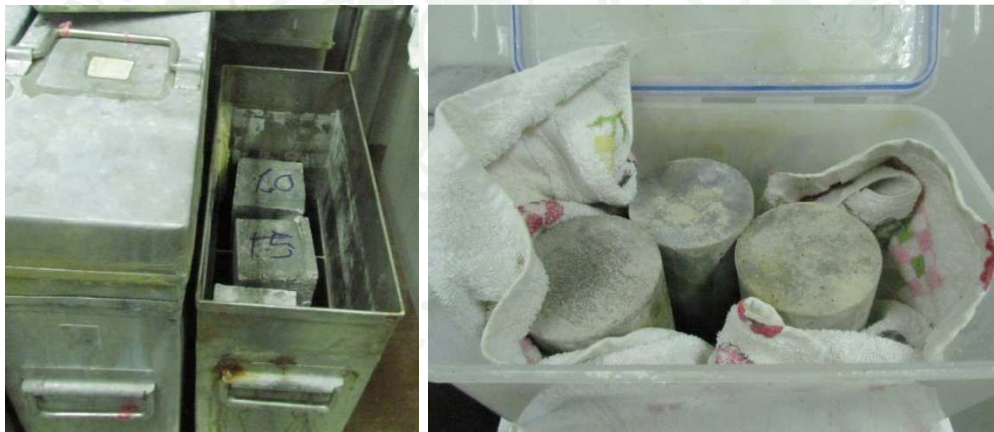
ภาพผนวกที่ ก7 การควบคุมอุณหภูมิหลังนำออกจากตู้ควบคุมอุณหภูมิ
