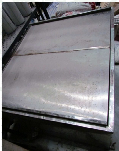
ภาพผนวกที่ ก5 ตู้เร่งปฏิกิริยาควบคุมอุณหภูมิและความชื้น
