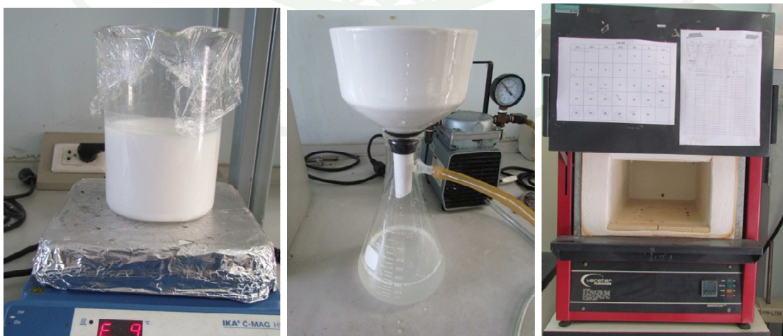
ภาพผนวกที่ ก11 อุปกรณ์สำหรับทดสอบการกระตุ้นซีโอไลท์
