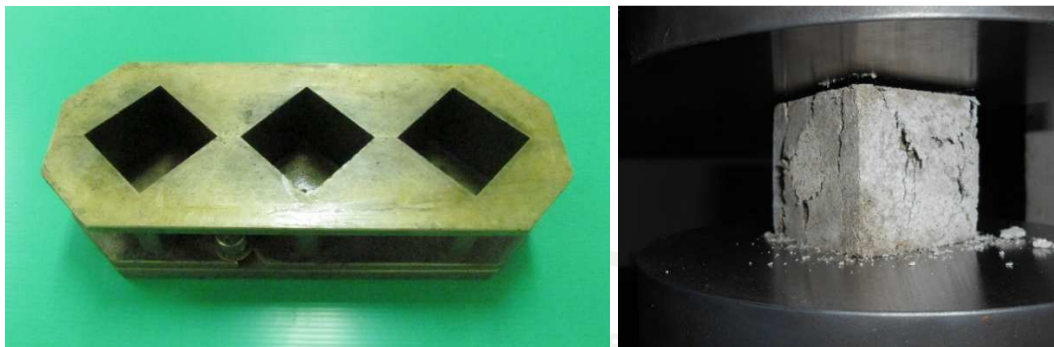
ภาพผนวกที่ ก3 แบบหล่อลูกบาศก์กมอร์ตาร์ท และการทดสอบลูกบาศก์กมอร์ตาร์ท
