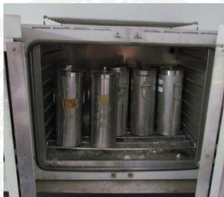
ภาพผนวกที่ ก1 อุปกรณ์การทดสอบด้วยวิธีเร่งปฏิกิริยาการขยายตัวของแท่งมอร์ต้าร์
