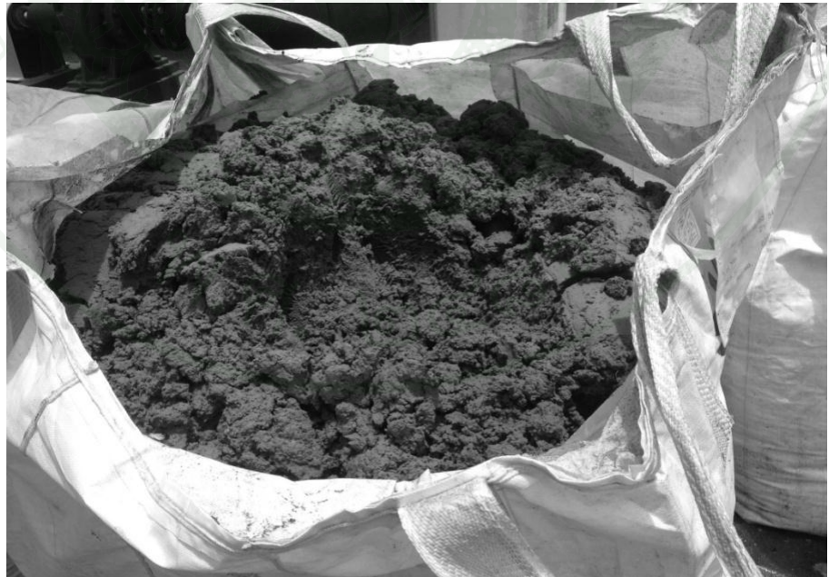
ภาพที่ 6 ตัวอย่างตะกอน AS โรงงานแปรงมันสำปะหลังแปรรูปของบริษัท สยาม มอดิไฟด์ สตาร์ช จำกัด
