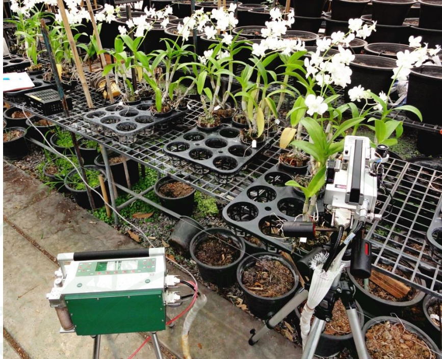
ภาพผนวกที่ 1 เครื่องวัดอัตราการสังเคราะห์ด้วยแสง รุ่น LI-6400XT (Li-cor Inc., Lincoln, NE, USA)
