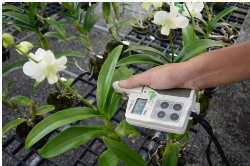
ภาพผนวกที่ 2 เครื่องวัดความเขียวใบ รุ่น SPAD-502, JAPAN
