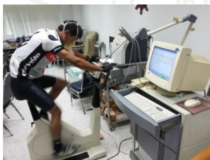
ภาพผนวกที่ ๑1 การทดสอบความสามารถการใช้ออกซิเจนสูงสุด ผ่านเครื่องวิเคราะห์ก๊าซ
