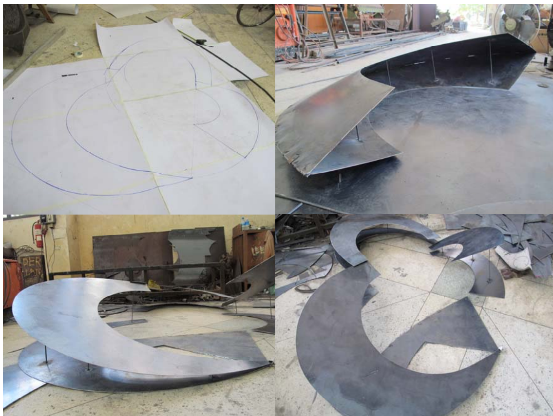
ภาพที่ 14 ภาพขั้นตอนการตัดแผ่นเหล็กตามแบบและประกอบ
