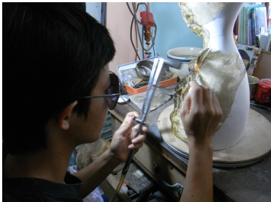
ภาพที่ 10 ภาพการเชื่อมตาข่ายทองเหลือง
