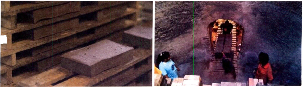
ภาพ 4-34 กระบวนการผลิตอิฐมอดุโบราณ ที่ใช้กับอาคารสถาบันกันตนา โดยชาวบ้านได้ต่ออายุอาชีพผลิตอิฐมอดุ ที่เกือบสูญหายไปจากการไม่มีการนำอิฐมอดุไปใช้ในการก่อสร้าง (ที่มา: ไอ-เอสบี, 28 พฤษภาคม 2556)
