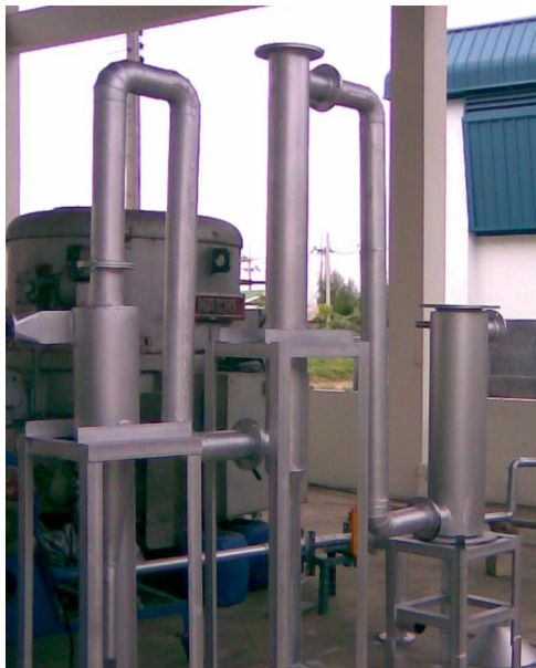
รูปที่ ก.2 ระบบทำความสะอาดเชื้อเพลิง
