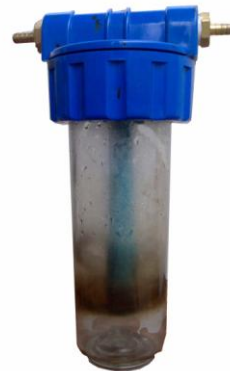
รูปที่ ก.10 หลอดแก้วสำหรับกรองทาร์ออกจากก๊าซเชื้อเพลิง
