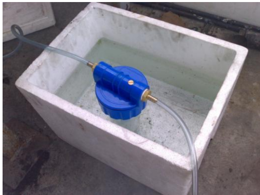
รูปที่ ก.10 หลอดแก้วสำหรับกรองทาร์ออกจากก๊าซเชื้อเพลิง
