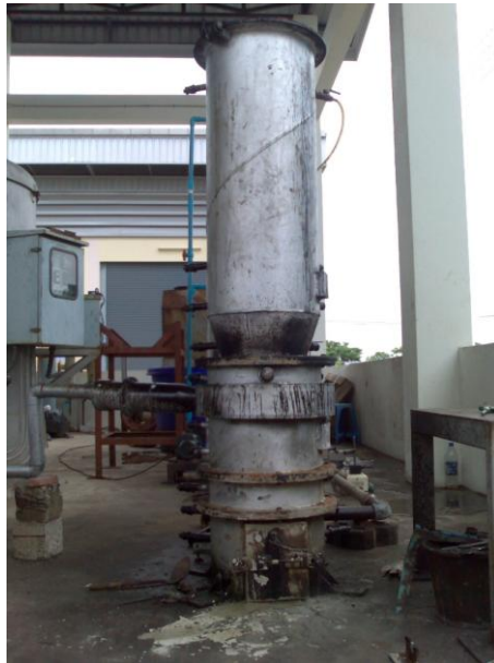
รูปที่ ก.1 เตาผลิตเชื้อเพลิงแบบไหลลง
