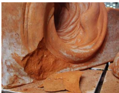
ภาพที่ 69 รอยแตกร้าวที่เกิดขึ้นในลักษณะของการระเบิดออกจากตัวชิ้นงาน
