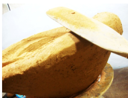
ภาพ ก. ขึ้นรูปชิ้นงานโดยการกดเป็นครึ่งวงกลม ภาพ ข. ใช้ไม้ตบให้ได้รูปทรงตามต้นแบบ
