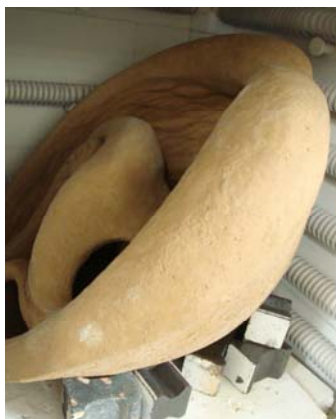
ภาพที่ 73 ภาพแสดงการใช้อิฐทนไฟรองตรงจุดรับน้ำหนัก เพื่อหนุนรับน้ำหนักที่อาจเกิดขึ้นอย่างฉับพลันเมื่อขึ้นงานหัตถ์ระหว่างการเผา
