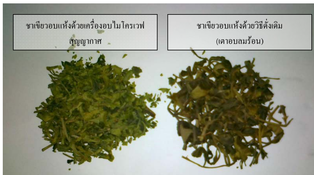
รูปที่ 4.11 เปรียบเทียบคุณภาพสีของชาเขียวอบแห้งด้วยเครื่องอบไมโครเวฟสุญญากาศ และ ชาเขียวอบแห้งด้วยวิธีดั้งเดิม (เตาอบลมร้อน)
