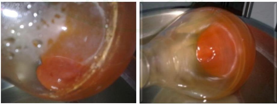
ภาพผนวกที่ ข2 การระเหยเอาตัวทำละลายออกด้วยเครื่องระเหยระบบสุญญากาศ
