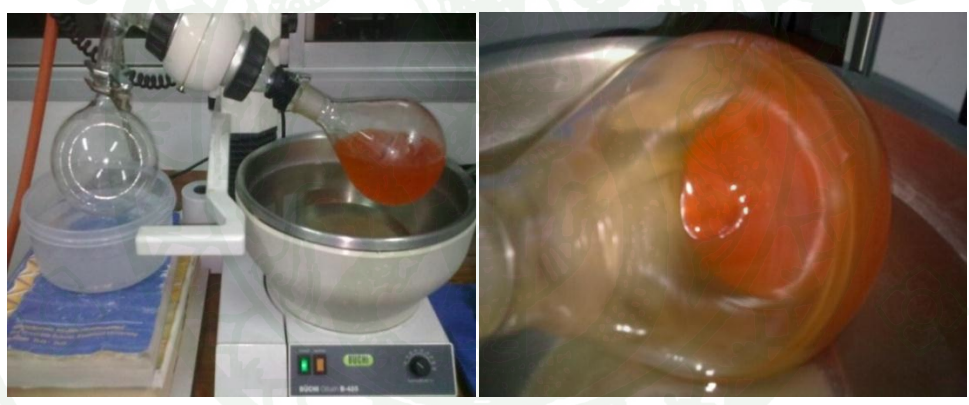
ภาพผนวกที่ ข2 การระเหยเอาตัวทำละลายออกด้วยเครื่องระเหยระบบสุญญากาศ
