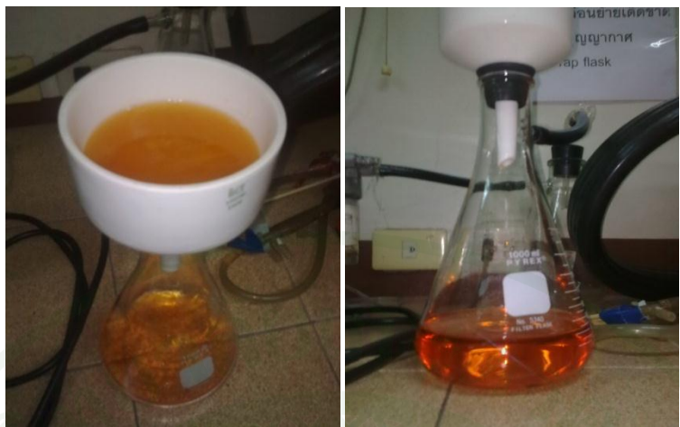
ภาพผนวกที่ ข1 การกรองเปลือกกุ้งออกด้วยเครื่องกรองระบบสุญญากาศ
