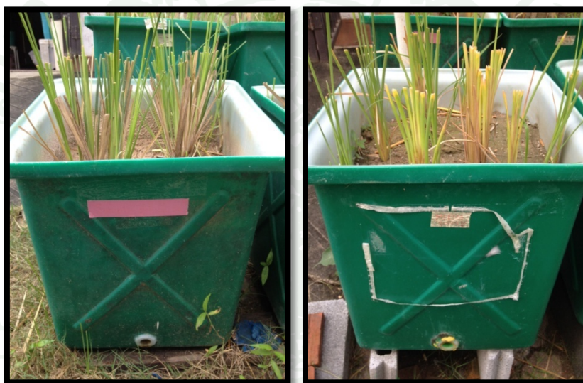
ภาพที่ 41 กระบะเพาะปลูกจำลองระบบแบบบึงประดิษฐ์โดยปลูก ธูปฤาษี และหญ้าแฝก
