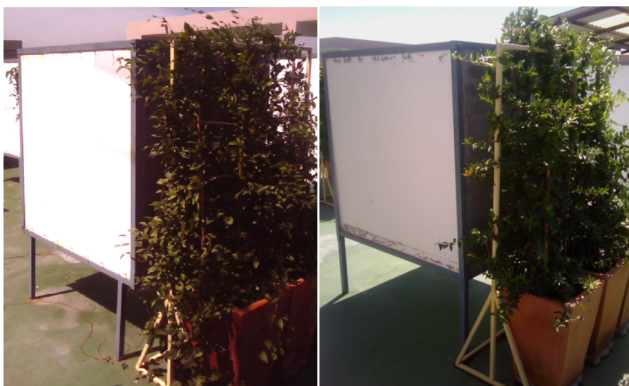
3. กล่องทดลองที่มีแผงกันแดดมะลิวัลย์ 4. กล่องทดลองที่มีแผงกันแดดสายน้ำผึ้ง
