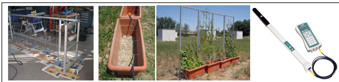
ภาพที่ 16 แผงกันแดดไม้เลื้อยกระถางปลูกไม้เลื้อยและเครื่องมือ Licor LAI 2200
