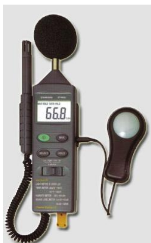
ภาพที่ 16 เครื่องมือวัดแสงลักซ์ ยี่ห้อ 4 in 1 Digital Multifunction Meter มิเตอร์รุ่น DT8820
