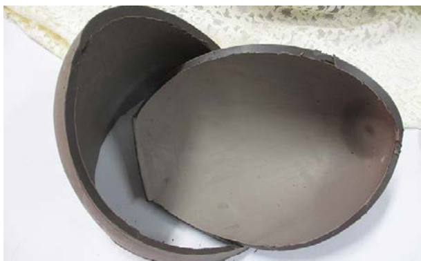
2. ตัดชิ้นส่วนจากดินให้ได้ตามรูปทรงที่ต้องการ
