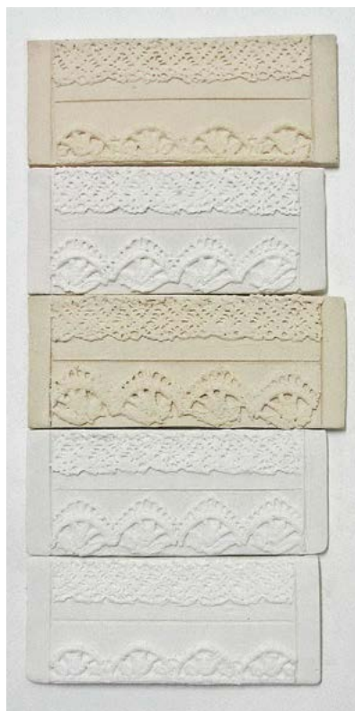
ภาพ: 3.3 แผ่นทดลองที่เผา 1200°C
