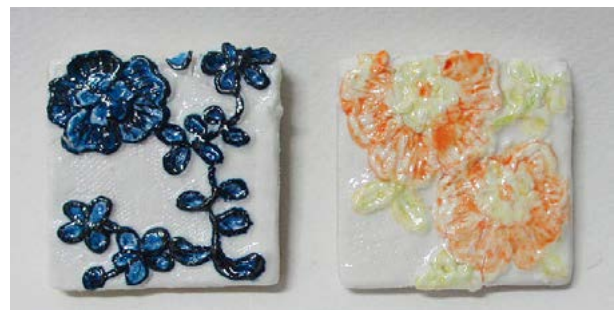
ภาพ: 3.27 เผาอุณหภูมิ 1230°C
