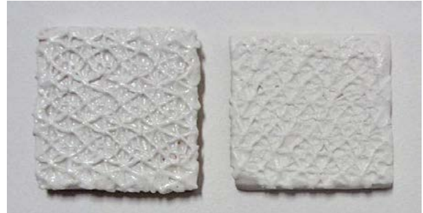
ภาพ: 3.23 เผาอุณหภูมิ 1230°C
