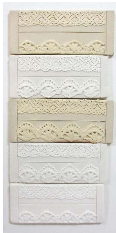
ภาพ: 3.4 แผ่นทดลองที่เผา 1230°C
