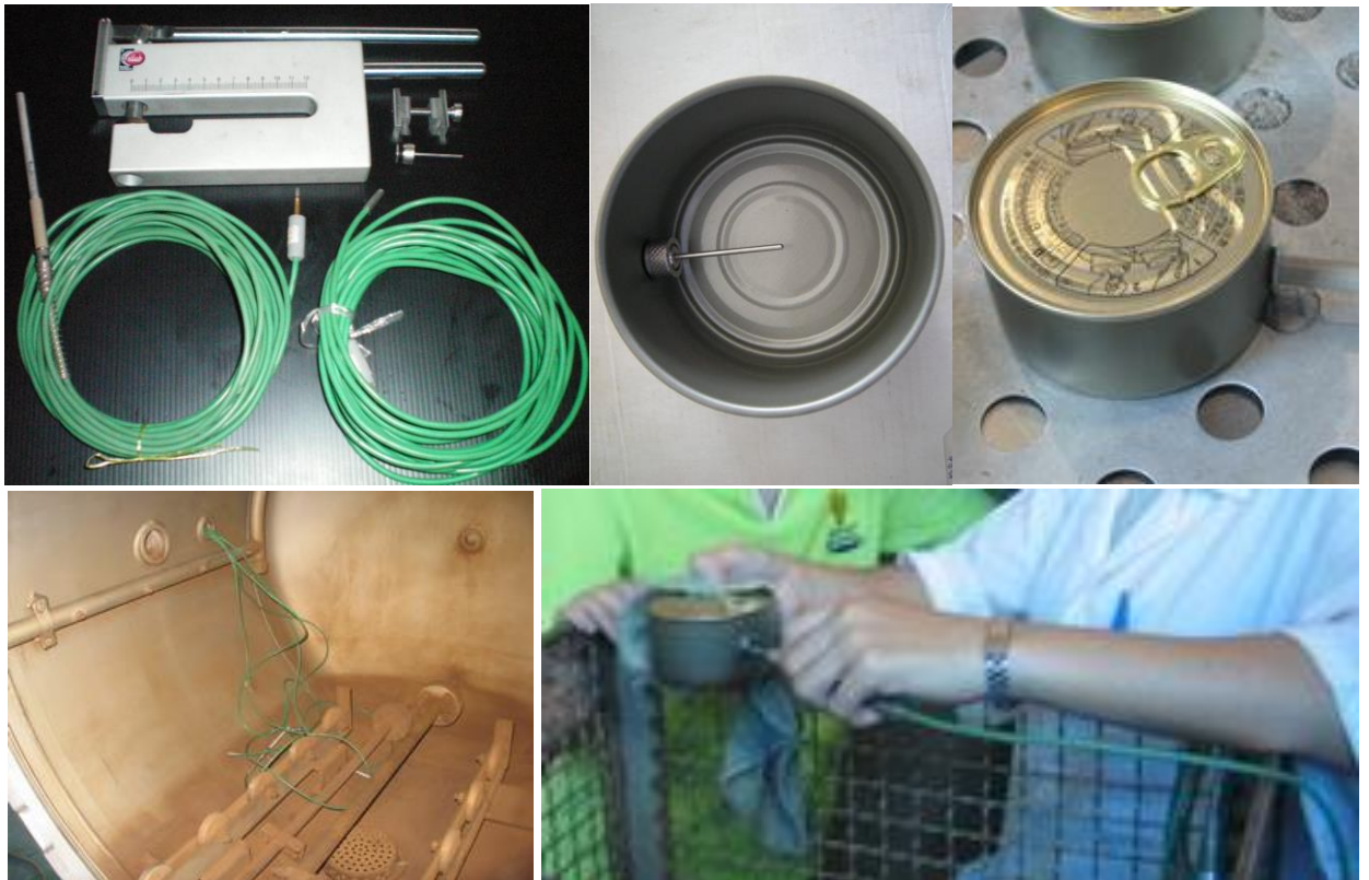
ภาพที่ 4.1.7 อุปกรณ์และการติดตั้งเข็มวัดอุณหภูมิคู่ควบ (thermocouple)
