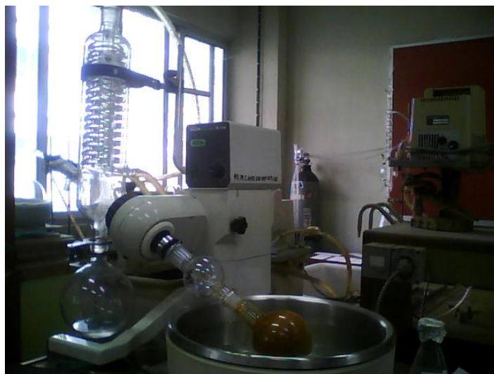
ภาพที่ 8 ภาพแสดงเครื่องระเหยสารแบบลดความดัน ซึ่งใช้ระเหยทั้งสารสกัดจากใบแก้ว และสารสกัดจากใบและรากขี้เหล็ก
