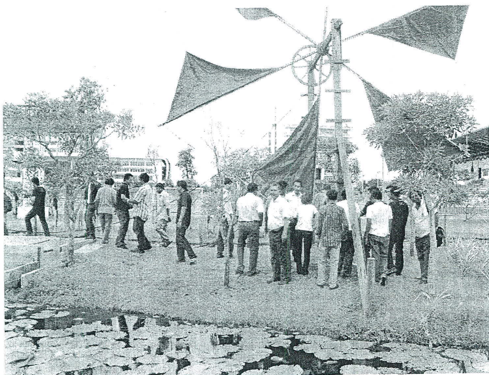
ภาพที่ ค.2 อธิบายและสาธิตการทำงานของกักันลมความเร็วรอบต่ำเพื่อการสูบน้ำและผลิตกระแสไฟฟ้า
