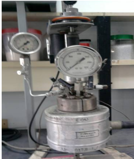
ภาพที่ 3-1 เครื่องปฏิกรณ์ไฮโดรเทอร์มัล พร้อมเครื่องควบคุมอุณหภูมิและความเร็วรอบ
