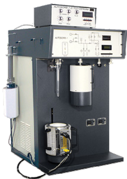
ภาพที่ 3-13 เครื่องวิเคราะห์พื้นผิวและปริมาตรรูพรุน (BET)
