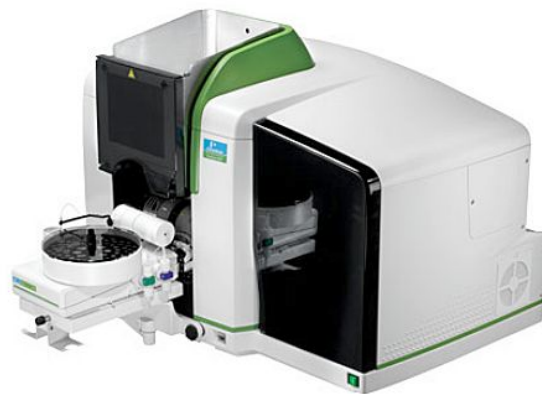
ภาพที่ 3-8 เครื่องมือวิเคราะห์ปริมาณธาตุในสารละลาย (AAS)
