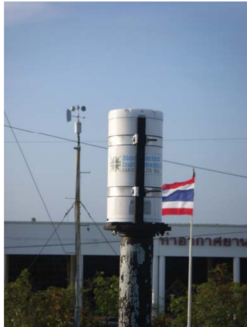
รูปที่ 20 เครื่องวัดรังสีอัลตราไวโอเล็ตแบบหลายช่องสัญญาณที่สถานีอุบลราชธานี
