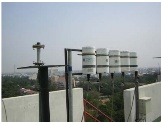
รูปที่ 31 การตั้งเครื่องวัดความเข้มรังสีอัลตราไวโอเล็ตแบบหลายช่องสัญญาณ กับเครื่อง Bentham spectroradiometer
