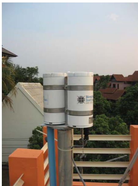
รูปที่ 23 การสอบเทียบเครื่องวัดรังสีอัลตราไวโอเล็ตแบบหลายช่องสัญญาณ ที่สถานี เชียงใหม่ เมื่อวันที่ 20-21 พฤษภาคม 2009
