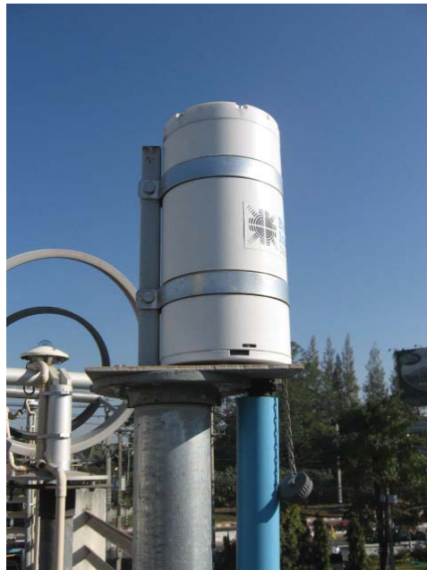
รูปที่ 19 เครื่องวัดรังสีอัลตราไวโอเล็ตแบบหลายช่องสัญญาณที่สถานีเชียงใหม่
