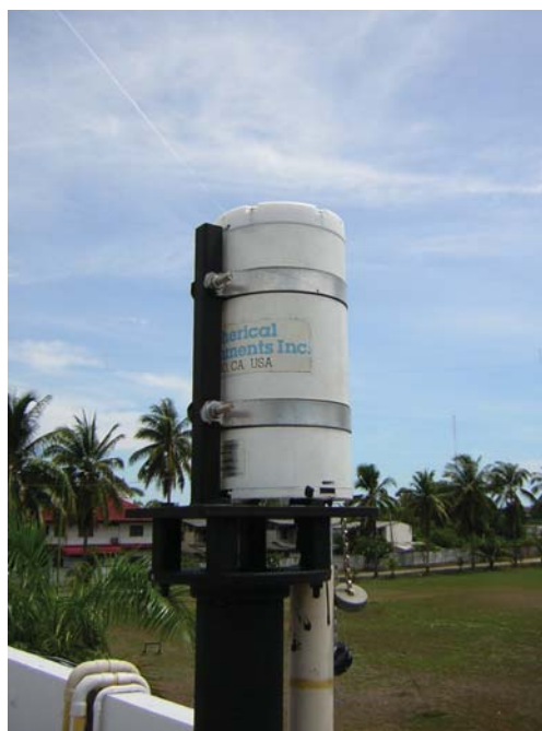
รูปที่ 22 เครื่องวัดรังสีอัลตราไวโอเล็ตแบบหลายช่องสัญญาณที่สถานีสงขลา
