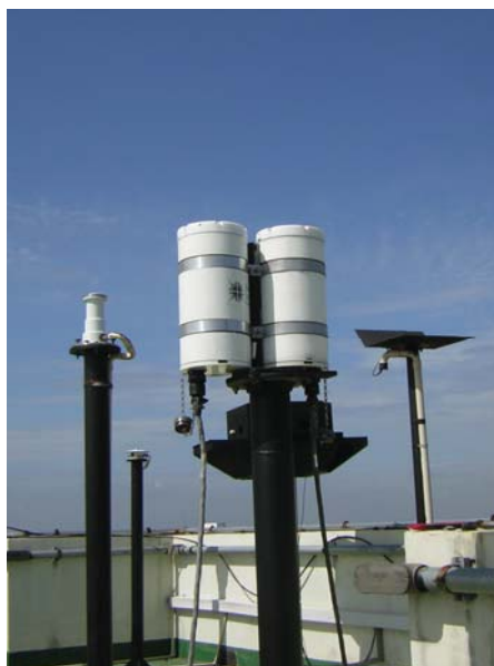
รูปที่ 25 การสอบเทียบเครื่องวัดรังสีอัลตราไวโอเล็ตแบบหลายช่องสัญญาณ ที่สถานี นครปฐม เมื่อวันที่ 24-25 เมษายน 2009
