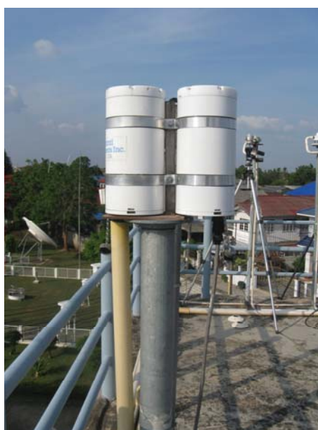
รูปที่ 24 การสอบเทียบเครื่องวัดรังสีอัลตราไวโอเล็ตแบบหลายช่องสัญญาณ ที่สถานี อุบลราชธานี เมื่อวันที่ 5-6 พฤษภาคม 2009
