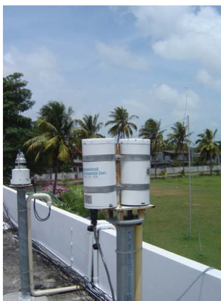
รูปที่ 26 การสอบเทียบเครื่องวัดรังสีอัลตราไวโอเล็ตแบบหลายช่องสัญญาณ ที่สถานีสงขลา เมื่อวันที่ 11-12 มีนาคม 2008
