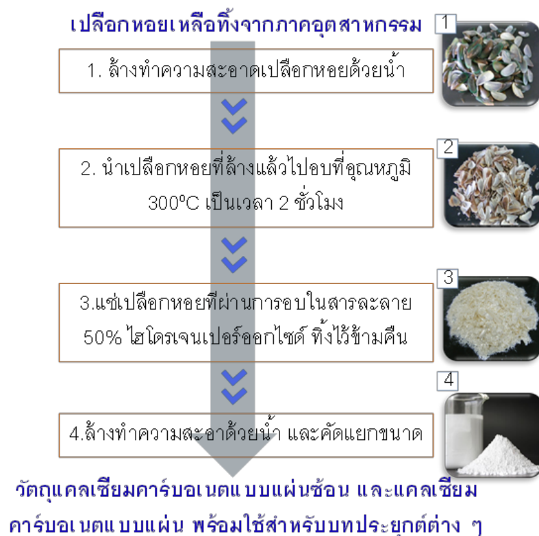
รูปที่ 3.1 แผนภาพแสดงวิธีการแปรรูปเปลือกหอยเหลือทิ้งจากอุตสาหกรรม ให้กลายเป็นแคลเซียมคาร์บอนเนตพร้อมใช้สำหรับบดประยุกต์ต่าง ๆ
