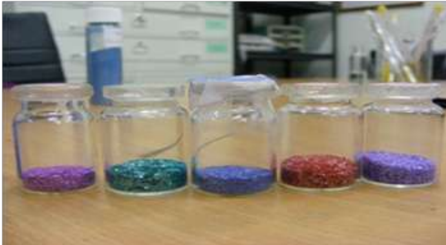
รูปที่ 3 แผ่นแคลเซียมคาร์บอเนตที่มีประกายแวววาวสกัดเปลือกหอยแมลงภู่ แล้วนำมาย้อมสี
