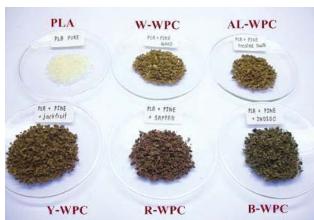
ภาพที่ 38 วัสดุคอมพอสิตชีวภาพที่ผ่านการผสมในเครื่องอัดรีดแบบสกรูคู่
