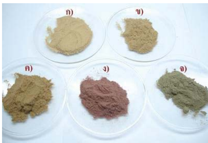
ภาพที่ 37 ผงไม้แต่ละชนิดหลังการปรับปรุงด้วย 3-TEPA ก) ผงไม้สน ข) ผงไม้สนที่ผ่านการปรับปรุงผิวด้วยสารละลาย NaOH ค) ผงไม้สนที่ย้อมสีเหลืองจากแก่นขนุน ง) ผงไม้สนที่ย้อมสีแดงจากแก่นไม้ฝาง จ) ผงไม้สนที่ย้อมสีน้ำเงินจากคราม
