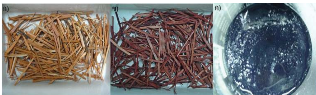
ภาพที่ 2 วัตถุดิบในการสกัดสีธรรมชาติในงานวิจัย ก) สีเหลืองจากแก่นขมิ้น ข) สีแดงจากแก่นไม้ฝาง ค) สีน้ำเงินจากคราม
