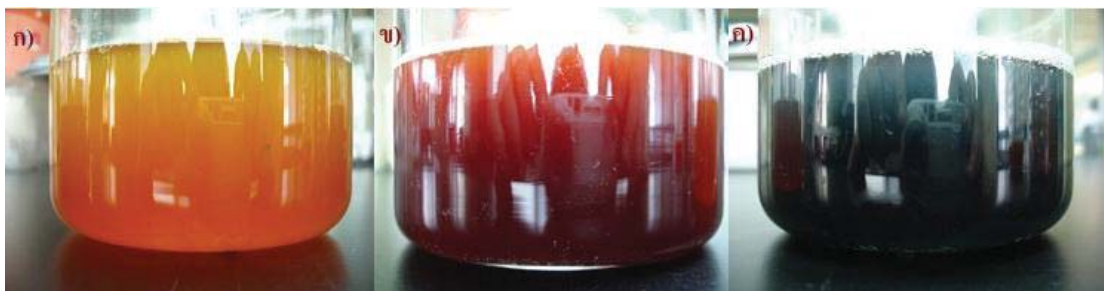
ภาพที่ 35 ลักษณะสีธรรมชาติที่ได้จากการสกัดก่อนการย้อมลงในผงไม้สน ก) สีเหลืองจากแก่นขนุน ข) สีแดงจากแก่นไม้ฝาง ค) สีนํ้าเงินจากคราม
