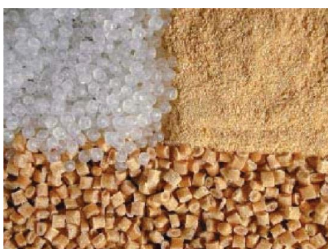
ภาพที่ 12 วัสดุหลักในการผลิตคอมพอสิต (บนซ้าย: เม็ดพลาสติกพอลิเอทิลีน, บนขวา: ผงไม้, ล่าง: เม็ดคอมพอสิตไม้-พลาสติก) [15]
