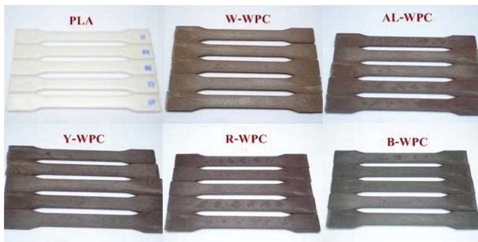
ภาพที่ 39 วัสดุคอมพอสิตหลังจากขึ้นรูปด้วยวิธีการฉีด (injection molding)
