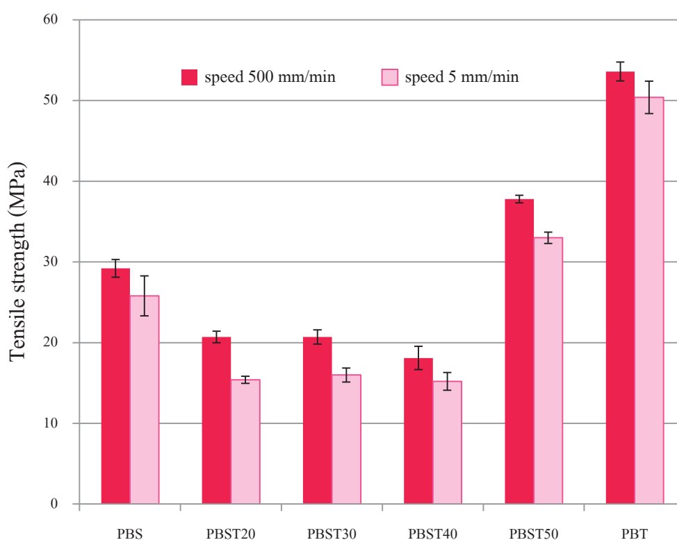
ภาพที่ 4.34 ความแข็งแรงต้านทานการดึงของพอลิเมอร์ผสม PBS/PBT ทดสอบด้วยอัตราการดึง 500 มิลลิเมตร/นาที
