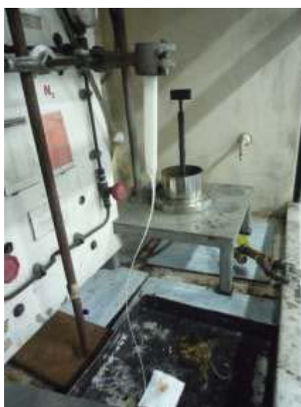
ภาพที่ 3.2 อุปกรณ์ในการทดสอบการเผาไหม้ในแนวตั้งตามมาตรฐาน UL-94
