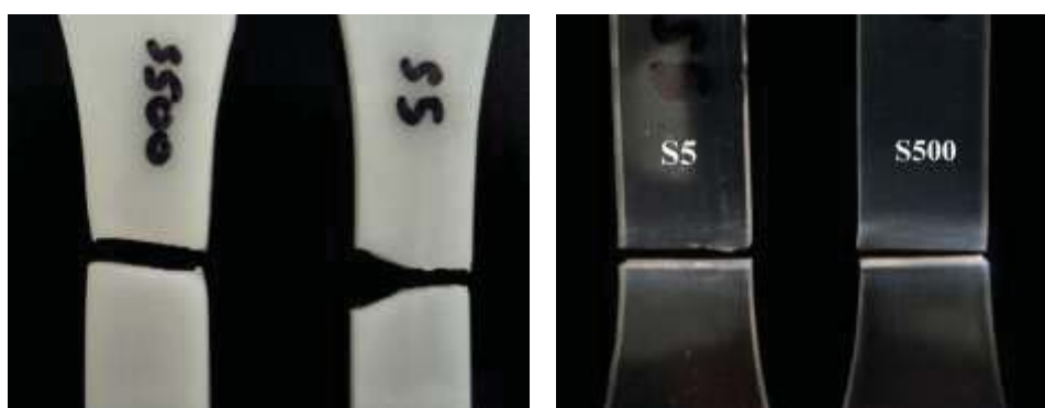
ภาพที่ ก.34 ลักษณะการแตกหักของ PBS (ซ้าย) และ PLA (ขวา) บริสุทธิ์ ที่อัตราการดึง 5 ม.ม./นาที่ และ 5 ม.ม./นาที่
