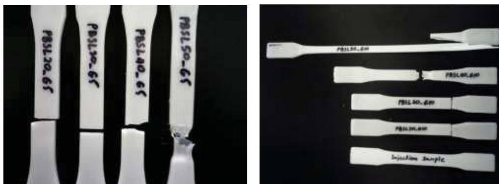
ภาพที่ ก.33 ลักษณะการแตกหักของตัวอย่างพอลิเมอร์ผสม PBSTx_G5 (ซ้าย) และ PBSTx_G10 (ขวา) หลังผ่านการดึงยืด
