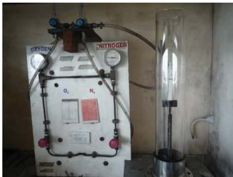
ภาพที่ 3.1 เครื่องทดสอบหาปริมาณออกซิเจนต่ำสุดที่ทำให้ตัวอย่างเกิดการติดไฟ (LOI)
