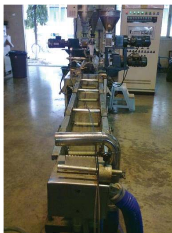
ภาพที่ 24 แสดงเครื่องอัดรีดชนิดเกลียวคู่ (twin screw extruder) ที่ใช้ในงานวิจัย
