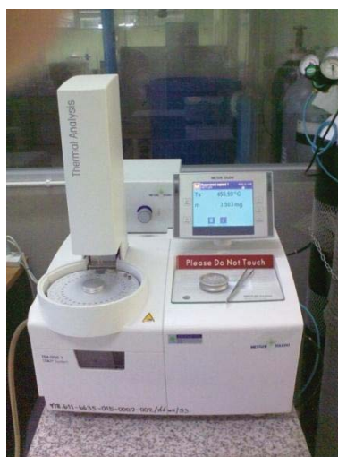
ภาพที่ 29 แสดงเครื่อง Thermal Gravimetric Analyzer (TGA) ที่ใช้ในงานวิจัย
