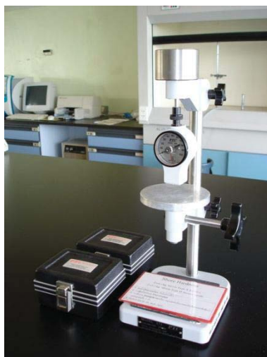
ภาพที่ 28 แสดงเครื่อง Shore Durometer Hardness
