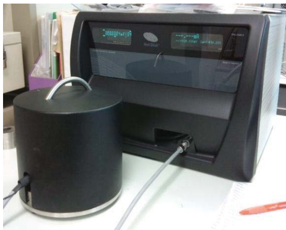
ภาพที่ 30 แสดงเครื่อง Thermal constant analyzer
