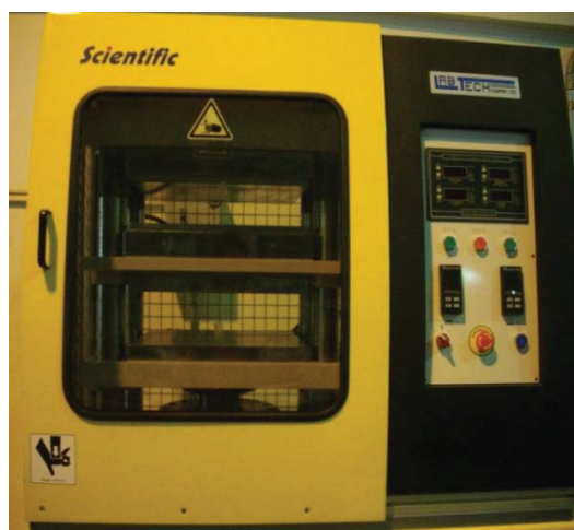
ภาพที่ 25 แสดงเครื่อง Compression Molding ที่ใช้ในงานวิจัย
