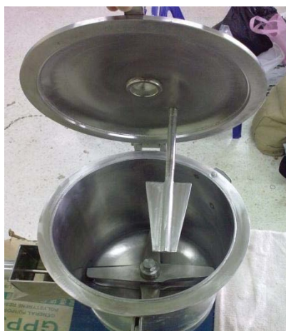
ภาพที่ 23 แสดงเครื่องปั่นผสมความเร็วสูง (High Speed Internal Mixer)
