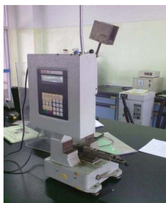
ภาพที่ 27 แสดงเครื่อง Impact Tester ของบริษัท Zwick
