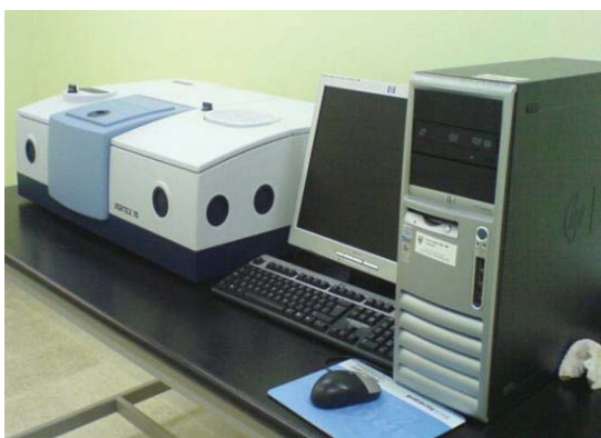
ภาพที่ 22 แสดงเครื่อง Fourier Transform Infrared Spectrophotometer (FTIR)
