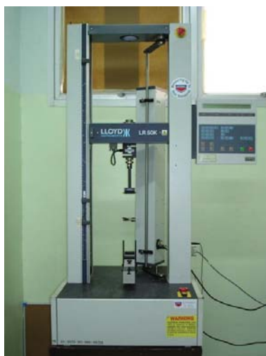
ภาพที่ 26 แสดง Universal testing machine ของ LLOYD Instruments รุ่น LR 50K
