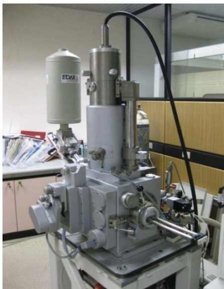
ภาพที่ 31 แสดงเครื่อง Scanning Electron Microscope ที่ใช้ในงานวิจัย
