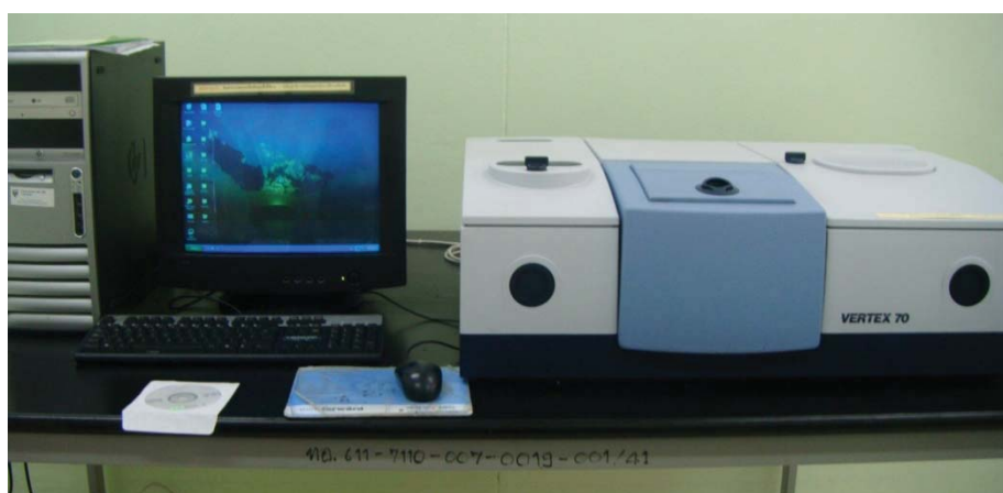
ภาพที่ 24 เครื่อง Fourier Transform Infrared Spectrometer (FTIR)
