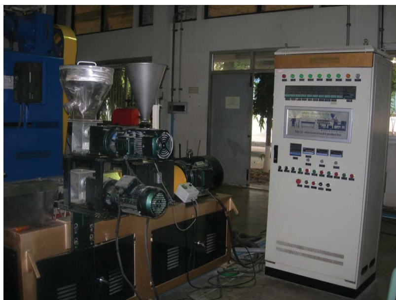
ภาพที่ 23 เครื่องอัดรีดแบบเกลียวหนอนคู่ (Twin screw-extruder)
