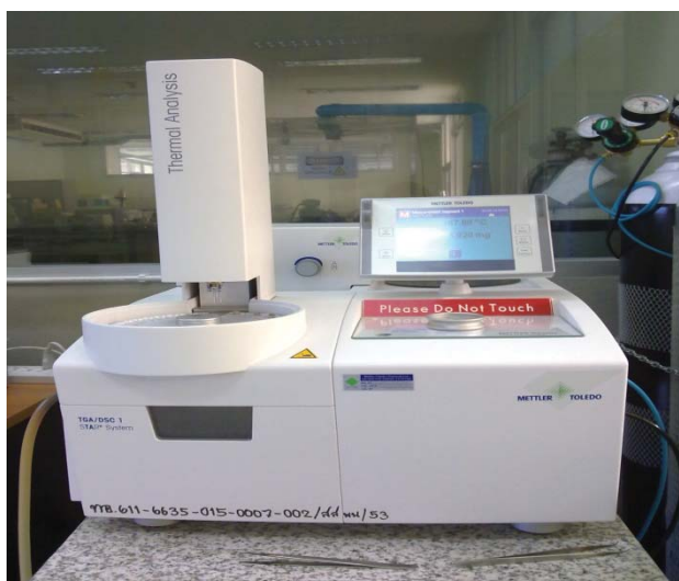
ภาพที่ 22 เครื่อง Thermogravimetric analyzer (TGA) ของบริษัท Mettler-Toledo Ltd.
