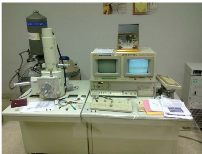
ภาพที่ 21 Scanning Electron Microscope ของบริษัท JEOL technics LTD
