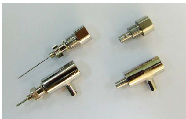
ภาพที่ 3.3 ตัวจับยึดเข็มฉีดยาโลหะที่มีและไม่มีเข็มโลหะ
