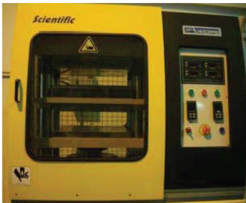
ภาพที่ 3. 7 เครื่อง compression molding ที่ใช้ในการขึ้นรูปชิ้นงานทดสอบ (Labtech Engineering)
