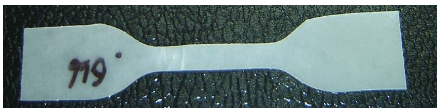
ภาพที่ 3.12 ชิ้นงาน dumbbell ที่ตัดด้วย Die cut ตาม ASTM D638
