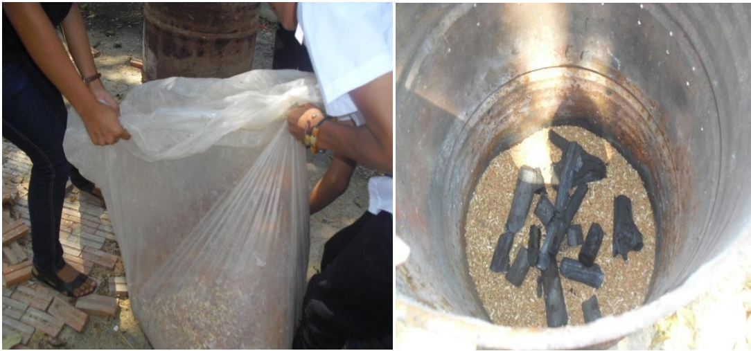
ภาพที่ 45 ผสมวัสดุจากท้องถื่นในถึงน้ำมันเก่าซึ่งเป็นเตารมควัน
