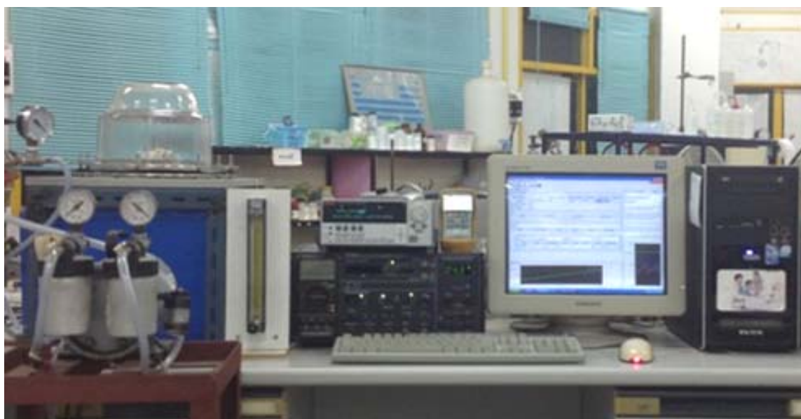
รูปที่ ๔.๙ อุปกรณ์สำหรับทดสอบการเป็นตัวตรวจจับแก๊สที่สร้างขึ้น
