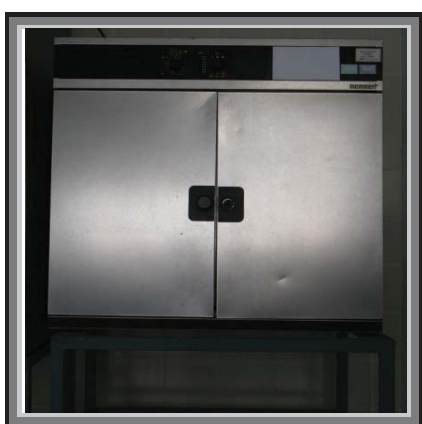
ภาพที่ 20 เทคนิคการอบด้วยไอระเหยของซูปเปอร์กลูในการตรวจลายนิ้วมือบนผลไม้
