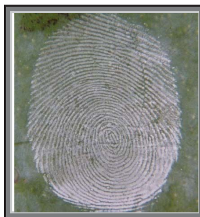
ภาพที่ 20 เทคนิคการอบด้วยไอระเหยของซูปเปอร์กลูในการตรวจลายนิ้วมือบนผลไม้
