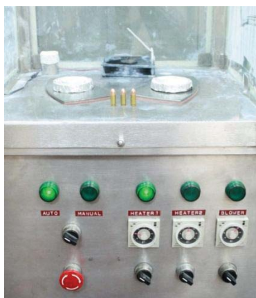
การทำงานของเครื่องทำความร้อนที่ 1 ในการอบลูกกระสุนปืน
