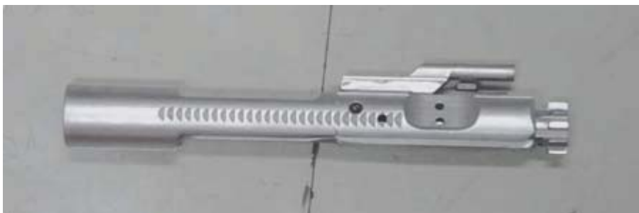
ภาพที่ 28 เครื่องลูกเลื่อน หรือส่วนประกอบสำคัญของเครื่องลูกเลื่อน
