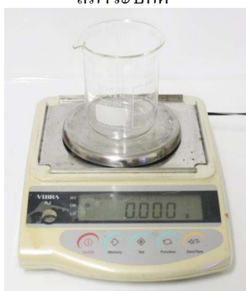
กดปุ่ม Reset เพื่อตั้งค่าน้ำหนักที่ อ่านได้ให้เท่ากับ 0
