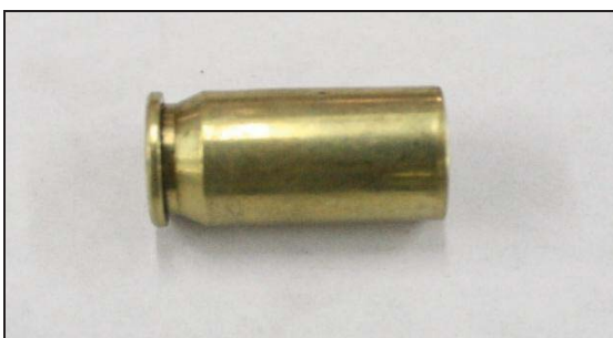
ภาพที่ 100 ไม่พบรอยลายนิ้วมือแฝงบนกระสุนปืนอโตเมติก ประเภททองเหลือง ขนาด 11 มิลลิเมตร โดยใช้วิธี Super glue ณ เวลาที่ 84 ชั่วโมง
