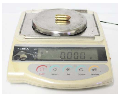
กดปุ่ม Reset เพื่อตั้งค่าน้ำหนักที่อ่าน ได้ให้เท่ากับ 0
