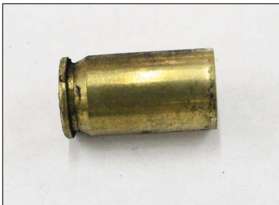
ภาพที่ 99 ไม่พบรอยลายนิ้วมือแฝงบนกระสุนปืนอโตเมติก ประเภททองเหลือง ขนาด 11 มิลลิเมตร โดยใช้วิธี Black powder ณ เวลาที่ 84 ชั่วโมง
