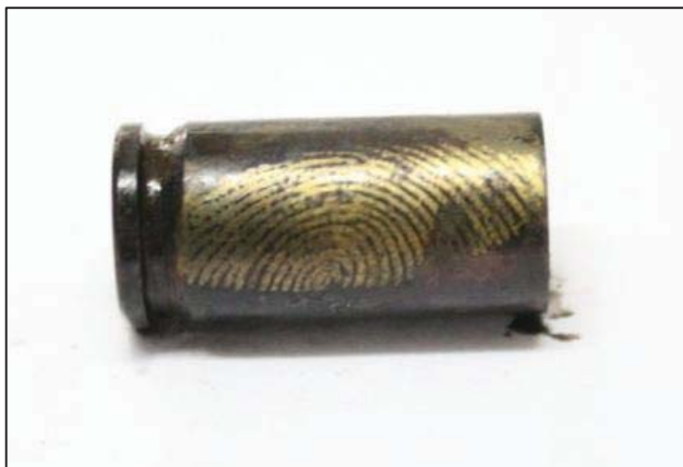
ภาพที่ 98 แสดงการปรากฏของรอยลายนิ้วมือแฝงบนกระสุนปืนอโตเมติก ประเภททองเหลือง ขนาด 9 มิลลิเมตร โดยใช้วิธี Gun blueing ณ เวลาที่ 84 ชั่วโมง
