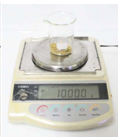
กดปุ่ม Reset เพื่อตั้งค่าน้ำหนักที่อ่าน น้ำหนัก Potassium sulfide 10 กรัม ได้ให้เท่ากับ 0
