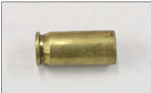
ภาพที่ 96 ไม่พบรอยลายนิ้วมือแฝงบนกระสุนปืนอโตเมติก ประเภททองเหลือง ขนาด 9 มิลลิเมตร โดยใช้วิธี Super glue ณ เวลาที่ 84 ชั่วโมง
