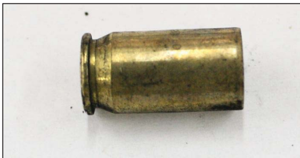
ภาพที่ 95 ไม่พบรอยลายนิ้วมือแฝงบนกระสุนปืนอโตเมติก ประเภททองเหลือง ขนาด 9 มิลลิเมตร โดยใช้วิธี Black powder ณ เวลาที่ 84 ชั่วโมง
