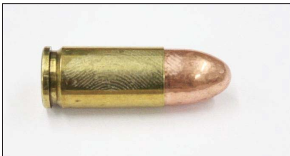
ภาพที่ 88 แสดงการปรากฏของรอยลายนิ้วมือแฝงบนกระสุนปืนอโตเมติก ประเภททองเหลือง ขนาด 9 มิลลิเมตร โดยใช้วิธี Super glue ณ เวลาที่ 24 ชั่วโมง
