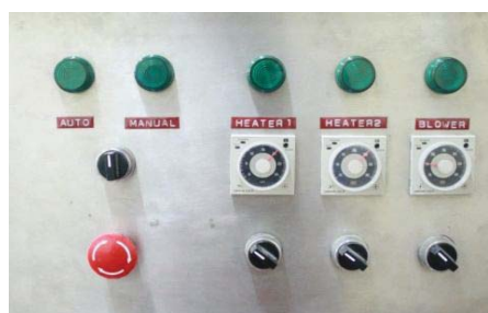
ตรวจสอบปุ่มหยุดการทำงานของตู้อบ Super glue ที่ใช้ในการวิจัย
