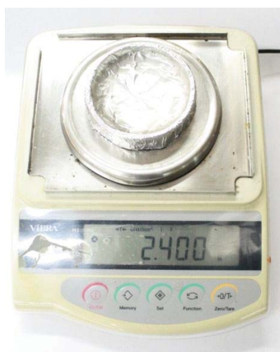
ชั่งน้ำหนักของน้ำบริสุทธิ์ ลงในถ้วยฟอยด์/โลหะ ตามอัตราส่วนของเครื่องอบ Super glue
