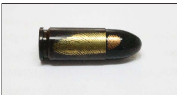
ภาพที่ 90 แสดงการปรากฏของรอยลายนิ้วมือแฝงบนกระสุนปืนอโตเมติก ประเภททองเหลือง ขนาด 9 มิลลิเมตร โดยใช้วิธี Gun blueing ณ เวลาที่ 24 ชั่วโมง
