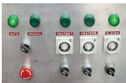
ตรวจสอบการทำงานของเครื่องดูดอากาศและนาฬิกาจับเวลาของเครื่องดูดอากาศ
