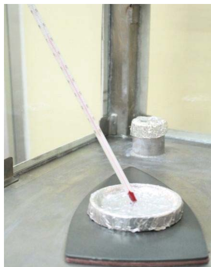
ตรวจสอบการทำงานของเครื่องทำความร้อนที่ 1
