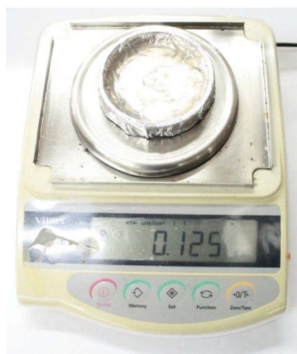
ชั่งน้ำหนักของน้ำยา Super glue ลงในถ้วยฟอยด์/โลหะ ตามอัตราส่วนของเครื่องอบ
