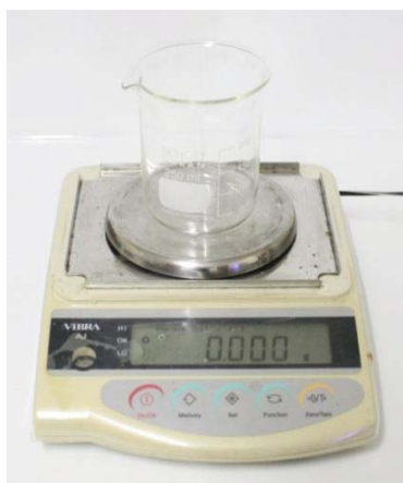
กดปุ่ม Reset เพื่อตั้งค่าน้ำหนักที่ อ่านได้ให้เท่ากับ 0
