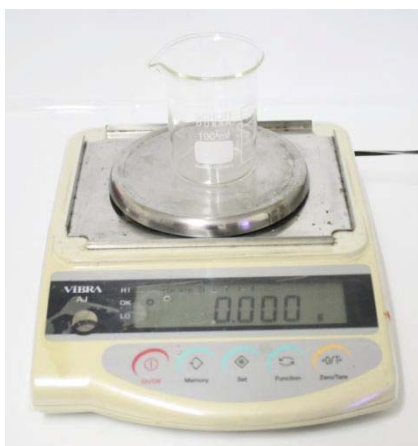
กดปุ่ม Reset เพื่อตั้งค่าน้ำหนักที่อ่าน น้ำหนัก Potassium sulfide 10 กรัม ได้ให้เท่ากับ 0
