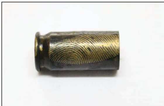
ภาพที่ 102 แสดงการปรากฏของรอยลายนิ้วมือแฝงบนกระสุนปืนอโตเมติก ประเภททองเหลือง ขนาด 11 มิลลิเมตร โดยใช้วิธี Gun blueing ณ เวลาที่ 84 ชั่วโมง
