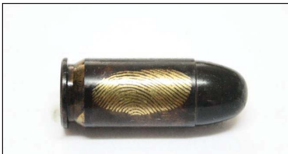
ภาพที่ 94 แสดงการปรากฏของรอยลายนิ้วมือแฝงบนกระสุนปืนอโตเมติก ประเภททองเหลือง ขนาด 11 มิลลิเมตร โดยใช้วิธี Gun blueing ณ เวลาที่ 24 ชั่วโมง
