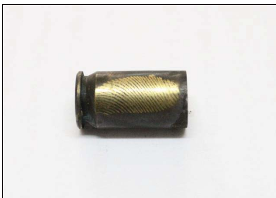
ภาพที่ 101 แสดงการปรากฏของรอยลายนิ้วมือแฝงบนกระสุนปืนอโตเมติก ประเภททองเหลือง ขนาด 11 มิลลิเมตร โดยใช้วิธี Perma blue ณ เวลาที่ 84 ชั่วโมง
